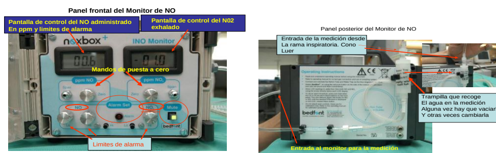
Figura 3. Descripción del sistema NoxBox.
