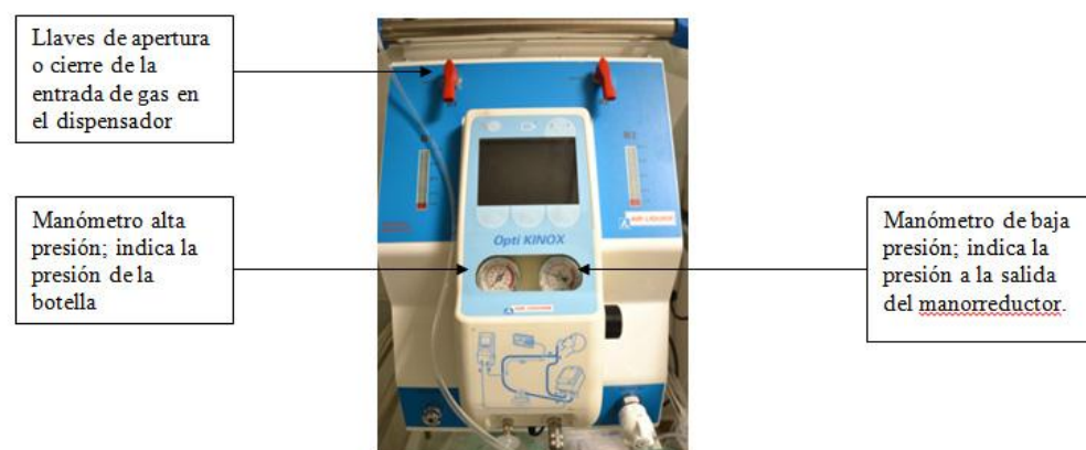
Figura 2. Descripción del sistema Optikinox.
